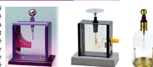
Fig. 155. Lloje të ndryshme të elektroskopave dhe elektrometereve neutrali dhe të elektrizuar
