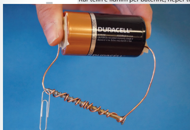
Fig. 163. Ndërtimi i një elektromagneti
