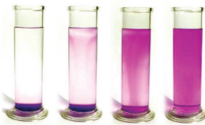
Fig. 122. Tretja e permanganatit të kaliumit në varësi nga temperatura, epruveta me ujin më të nxehtë e kalëro dritat, më së shumti ngjyros, kurse më e ftohta, epruveta e parë majtas, më së pak ngjyros
