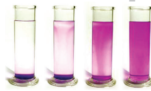
Fig. 122. Tretja e permanganatit të kaliumit në varësi nga temperatura, epruveta me ujë më të nxehtë e kalërisa djathtas, më së shumti ngjyros, kurse më e ftohtë, epruveta e parë majtas, më së paku ngjyros
