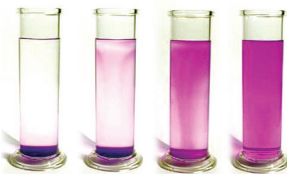
Fig. 122. Tretja e permanganatit të kaliumit në varësi nga temperatura, epruveta me ujë më të nxehtë e kalëto dështas, më së shumti ngjyros, kurse më e ftohtë, epruveta e parë majtas, më së paku ngjyros
