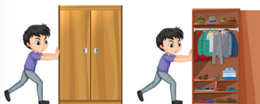
Forca e fërkimit të dollapit me peshë të lehtë dhe të rëndë
