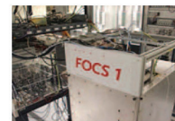
Figura 2.40. Ora atomike FOCS1 në Zürich; e cila punon që nga viti 2004 me një gabim, 1 cil mbërrin vlerën e 1s për 30 milionë vjet. Që kjo orë të mund të funksionojë si duhet, duhet t'i mbojmë atomet e cesiumit në temperaturë konstante qëfar zëros absolute rreth -273 °C.
