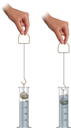
Matja e vëllimit me anë të cilindrit të shkallëzuar
