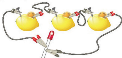
Fig. 2.2. Lidhja e baterisë së ndërtuar nga limonët
